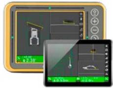
Bewährte Displays der GX-Serie und ein neues Android-Tablet für MC-Mobile-Systeme
