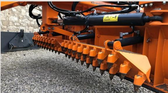
Hinter dem zweiteiligen Schild gibt es zwei Balken auf denen **Aufreißzähne** montiert werden können. Diese Aufreißzähne können hydraulisch bedient werden zum Losreißen von Materialien.
