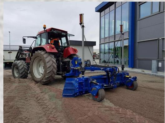
Mit den optionalen Aufreißzähnen kann den Boden bearbeitet werden (bei rauer und unebener Oberfläche), entweder vorangehend oder im Gleichen Arbeitsgang um eine lockere Struktur zu erreichen. Die Aufreißzähnen erhöhen die Leistung des AP Schlepperhobels.
