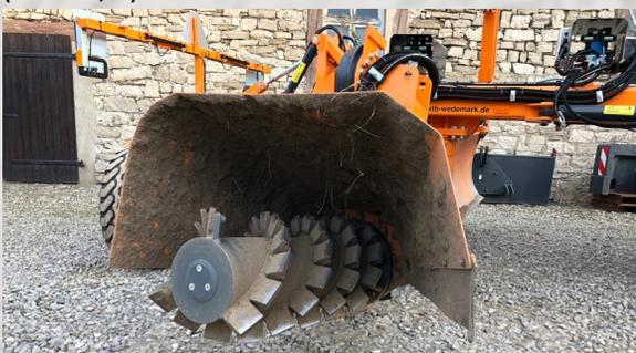
Statt ein Graben zu pflügen ist es auch möglich eine erhobene Straßenseite abzufräsen zur Verbesserung der Drainage. Eine hohe Straßenseite kann zu schlechter Drainage und zum Wachstum von Pflanzen und Gräser führen. Zur Lösung kann die AP Grader Plane optional ausgerüstet werden mit einer **Bankettfräse**.
